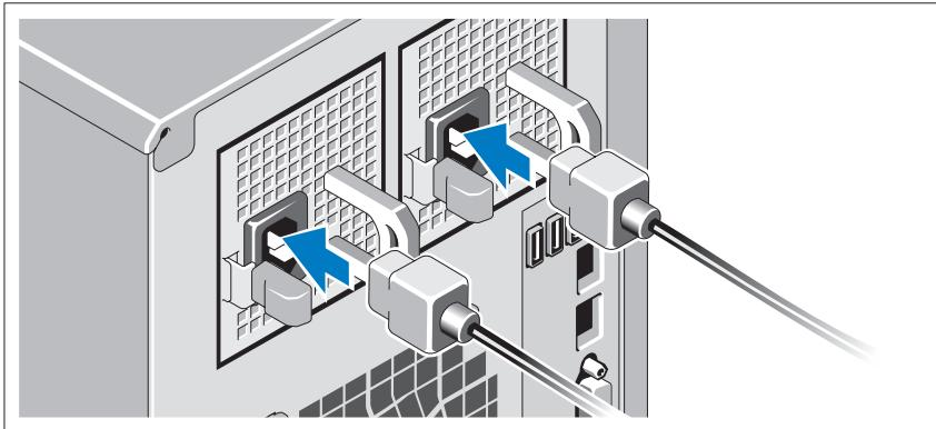
将系统电源电缆连接至系统，如果使用显示器，将显示器电源电缆连接至显示器。
