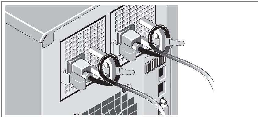
Tekuk kabel daya sistem dalam bentuk lingkaran seperti terlihat pada gambar dan kunci kabel dengan tali pengikat yang disediakan.
