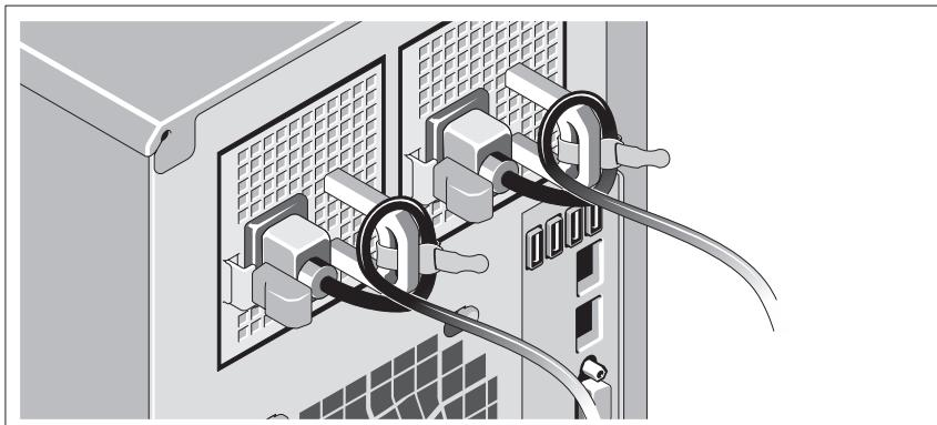
システムの電源ケーブルをループ状に曲げ（図を参照）、付属のストラップで固定します。
