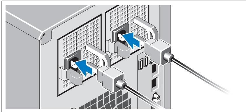
시스템의 전원 케이블을 시스템에 연결하고, 모니터를 사용하는 경우 모니터의 전원 케이블을 모니터에 연결합니다.
